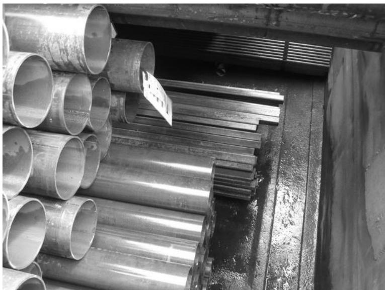
Рисунок 4 – Размещение грузов в железнодорожном полувагоне после экспериментальной проверки
