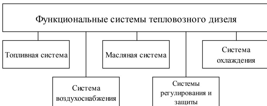
Рисунок 1 – Функциональные системы тепловозного дизеля
