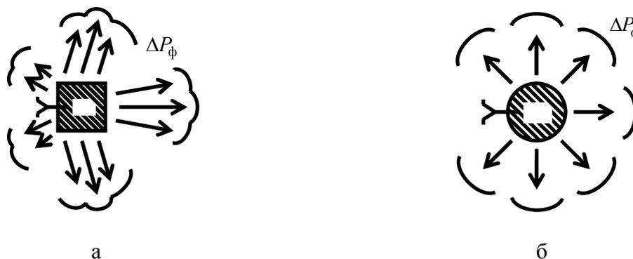
Рисунок 1 – Схемы разлета продуктов взрыва различной конфигурации
