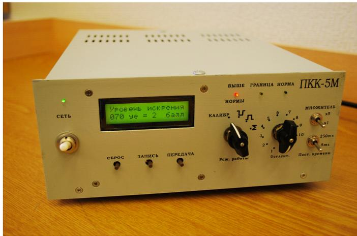
Рисунок 2 – Внешний вид прибора контроля качества коммутации ПКК-5М
