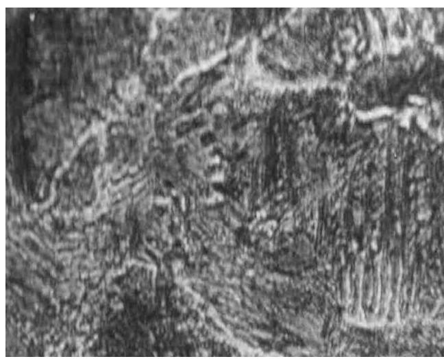
Рисунок 7 – Микроструктура металла, наплавленного проволокой 30ХГСА (перлит + избыточный феррит)
