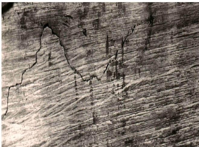
Рисунок 4 – Трешины на рабочей поверхности гребня бандажа
