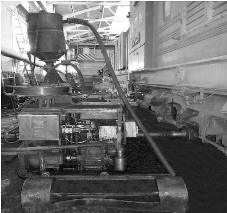
Рисунок 3 – Вид установки для наплавки гребней бандажей
