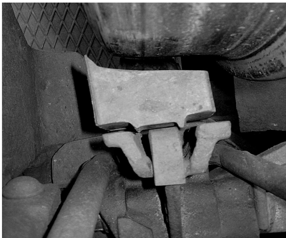
Рисунок 3 – Односторонний износ колодки
