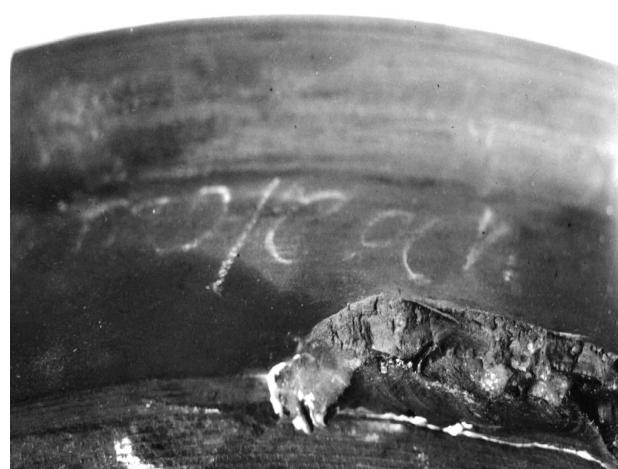
Рисунок 5 – Откол гребня бандажа колесной пары электровоза ПЭ2<sup>М</sup> № 19
