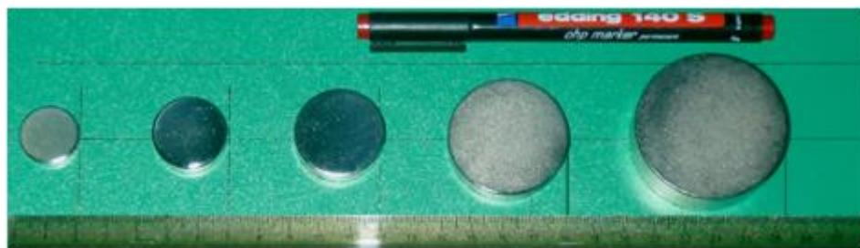
Рисунок 5 – Вид неодимовых супермагнитов
