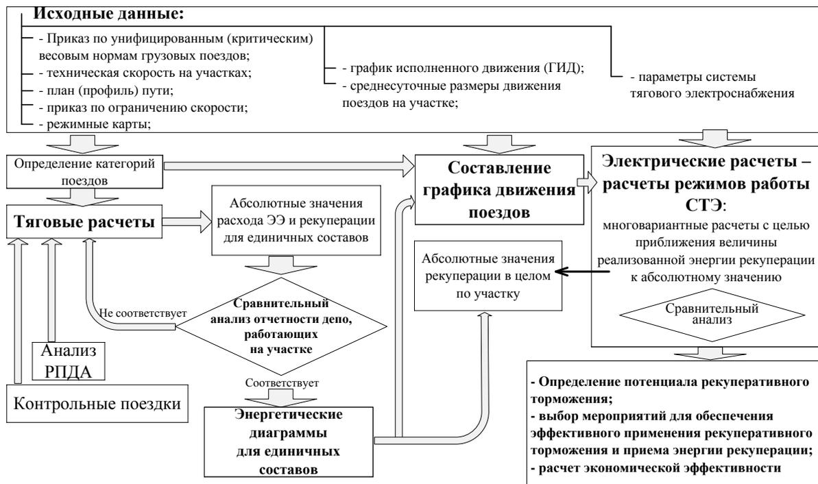
Рисунок 1 – Блок-схема расчетной модели системы тягового электроснабжения (СТЭ) для определения потенциала рекуперативного торможения
