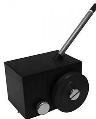
Рисунок 6 – Вид твердомера Константа-ТК
