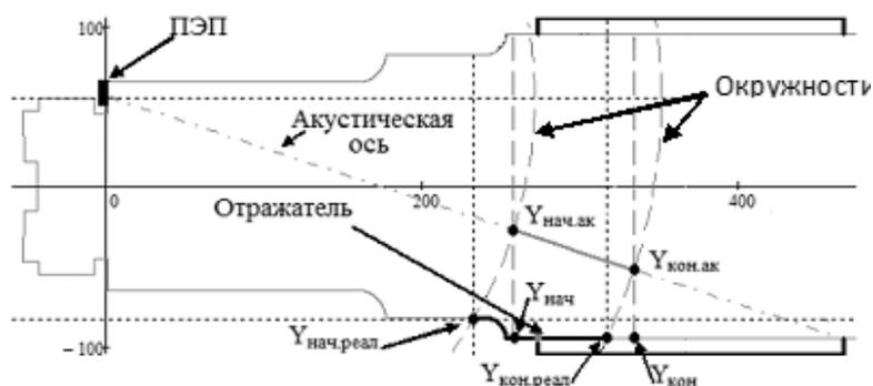
Рисунок 3 – Смещение реальной зоны контроля при контроле оси в зоне под внешней кромкой ступицы по РД 07.09.97
