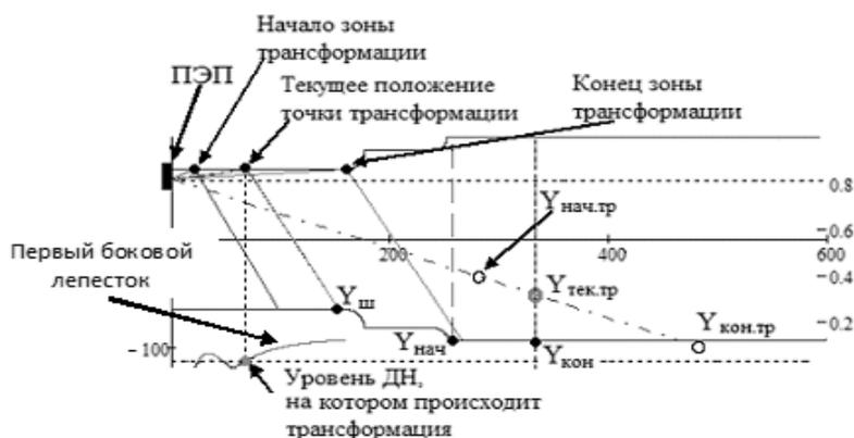
Рисунок 11 – Зона трансформации ультразвуковой волны на шейке оси РУ-1 при положении (по времени) текущей точки трансформации, совпадающем с концом зоны контроля по РД 07.09-97
