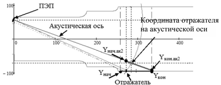
Рисунок 5 – Зона контроля по РД 07.09-97 и ее смещение при использовании ПЭПа 24 градуса для оси РУ-1
