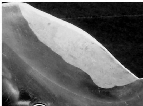
Рисунок 2 – Макроструктура наплавленного гребня цельнокатаного колеса
