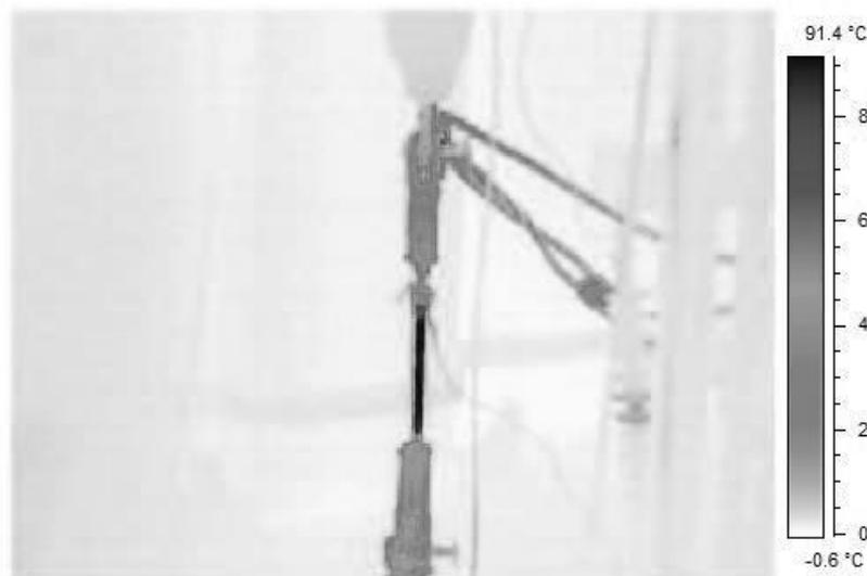
Рисунок 3 – Термограмма нагрева при разрыве контактного провода марки Бр1Ф -100 (0,15 %Sn) при температуре 90 °С (в момент разрыва)
