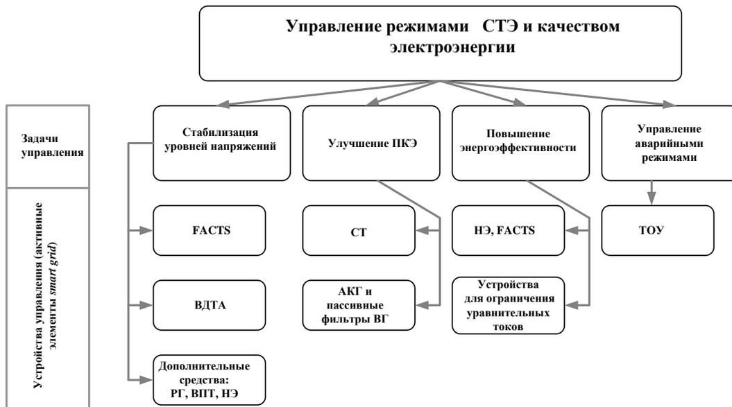
Рисунок 2 – Классификация средств управления режимами СТЭ:
