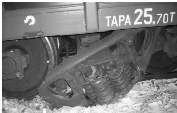
Рисунок 1 – Следствие излома боковой рамы тележки
