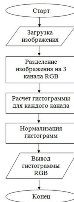
Рисунок 6 – Блок-схема программного модуля определения качества изображений
