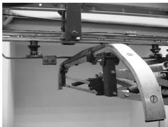
Рисунок 10 – Боек модуля имитации ударных воздействий
