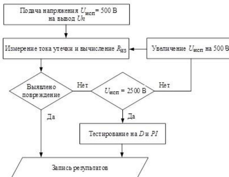
Рисунок 3 – Алгоритм тестирования корпусной изоляции ТЭД
