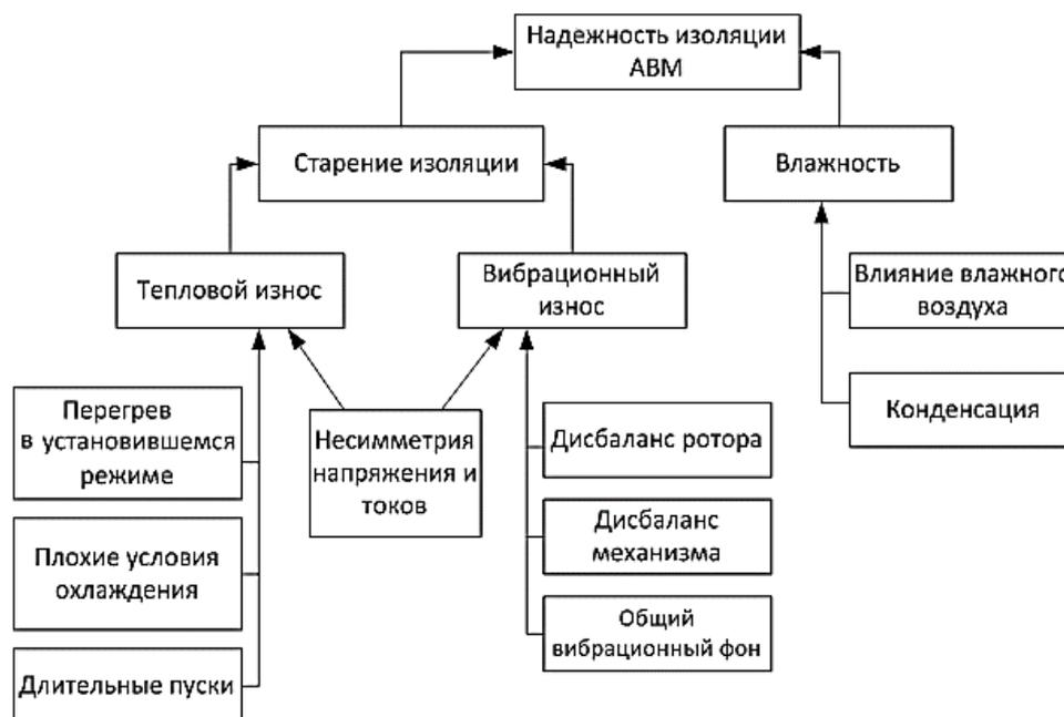
Рисунок 6 – Систематизация разрушающих факторов, снижающих надежность изоляции АВМ электровозов переменного тока
