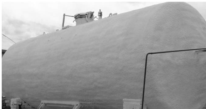
Теплоизоляционный слой на опытном образце
