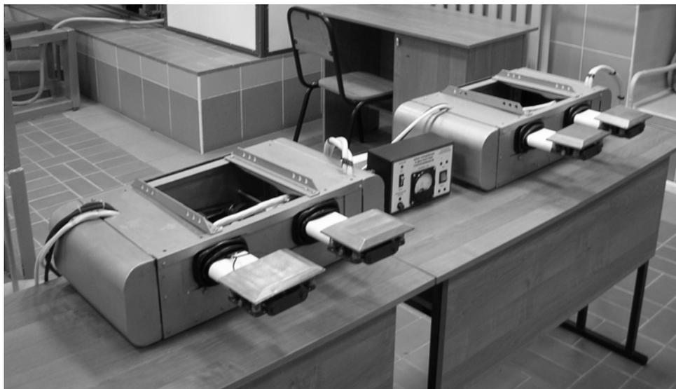
Рисунок 5 – Общий вид токоприемника ТМС
