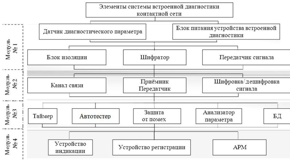
Рисунок 1 – Структурная схема системы встроенной диагностики контактной сети
