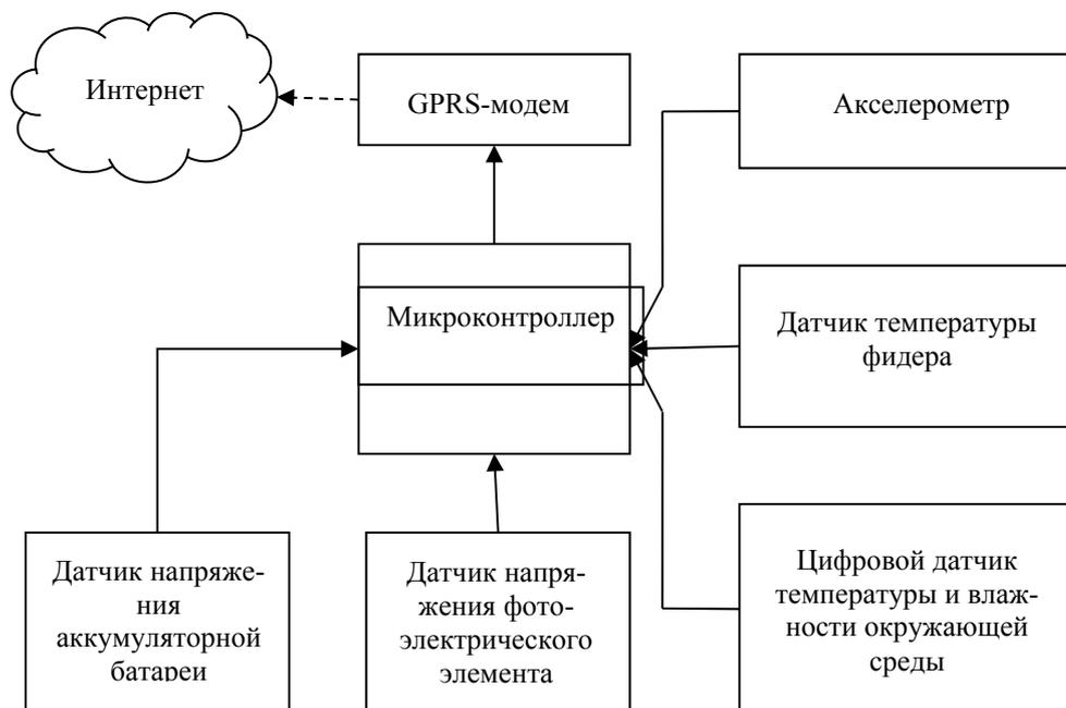
Рисунок 5 – Функциональная схема автономного измерителя
