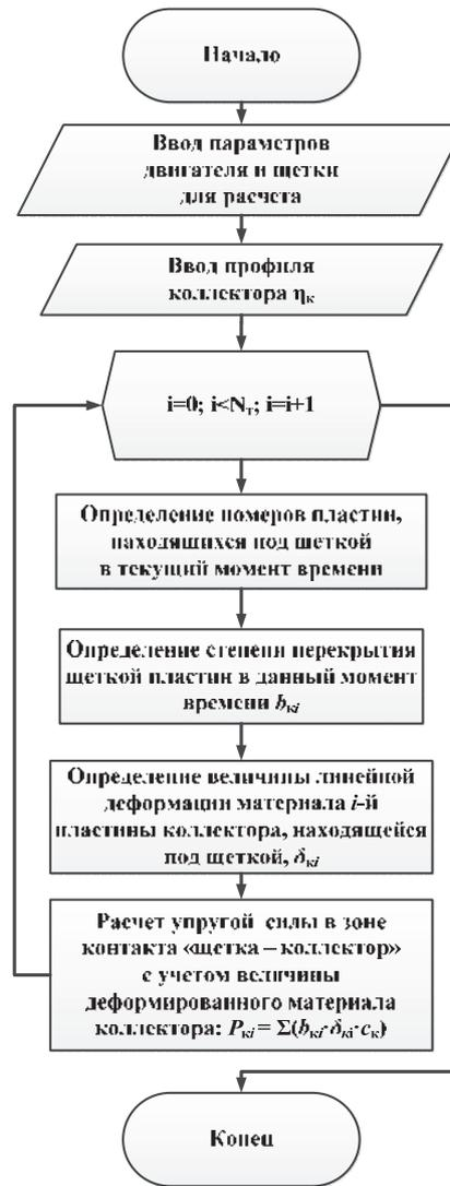
Рисунок 2 – Алгоритм для расчета взаимодействия элементов контакта «щетка – коллектор» при работе двигателя
