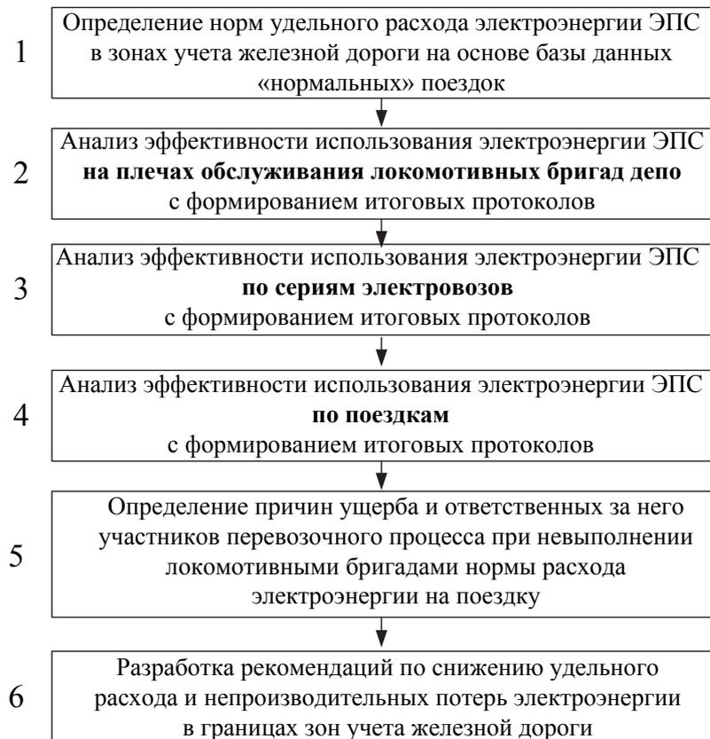
Рисунок 2 – Алгоритм снижения удельного расхода и непроизводительных потерь электроэнергии в границах зон учета железной дороги
