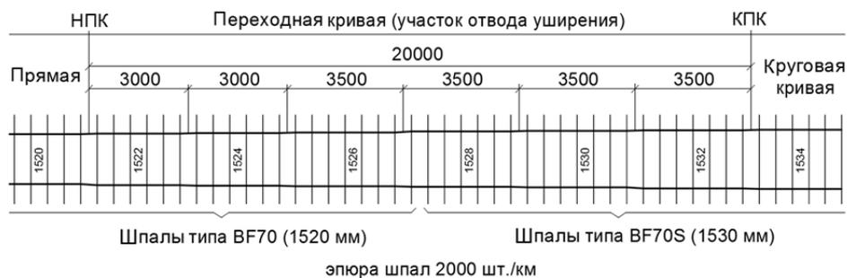
Рисунок 5 – Схема отвода ширины колеи 1520 – 1534 мм на шпалах типа BF70 и BF70S в кривых радиусом 299 м и менее при длине переходных кривых (участок отвода уширения) 20 м
