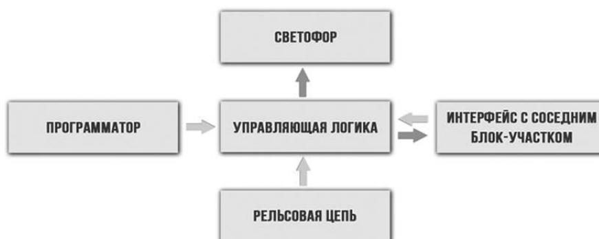
Рисунок 1 – Обобщенная структурная схема модели блок-участка
