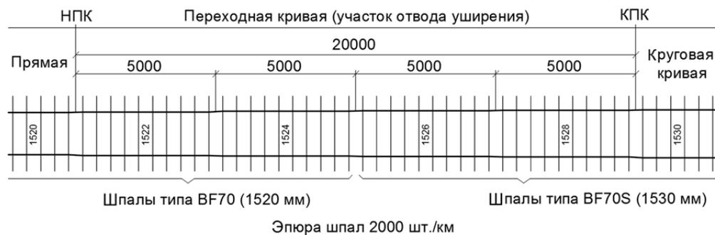
Рисунок 4 – Схема отвода ширины колеи 1520 – 1530 мм на шпалах типа BF70 и BF70S в кривых радиусом от 349 до 300 м при длине переходных кривых (участок отвода уширения) 20 м
