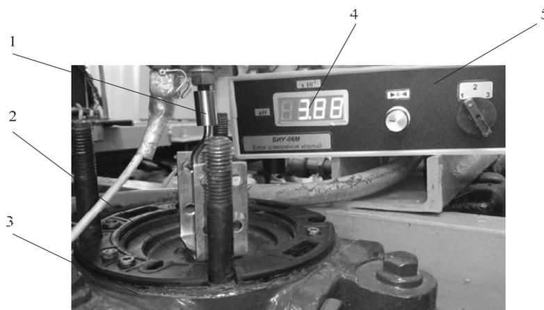
Рисунок 5 – Схема крепления зацепа динамометра к уравнительному поршню:
