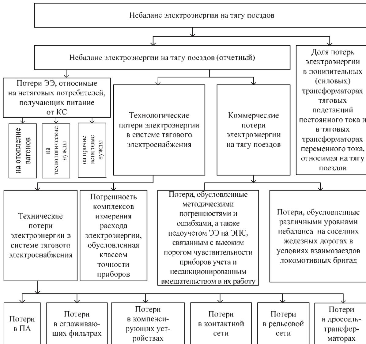
Рисунок 1 – Структура составляющих небаланса электроэнергии на тягу поездов
