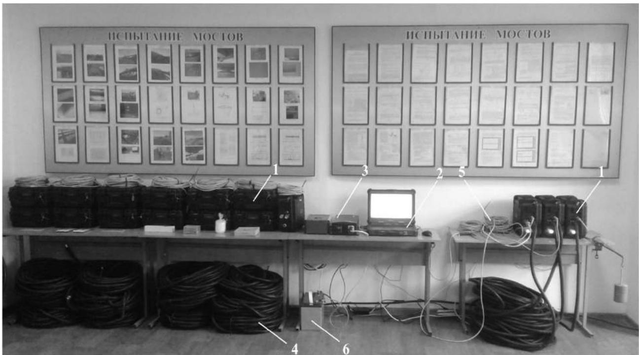
Рисунок 1 – Тензометрический измерительно-вычислительный комплекс для измерения относительных деформаций и напряжений в конструкциях: 1 – измерительные модули (16 шт.); 2 – полупромышленный ноутбук; 3 – синусный инвертор; 4 – межмодульный соединительный кабель; 5 – соединительный кабель между измерительным модулем и первичным преобразователем (тензомостом); 6 – аккумуляторная батарея
