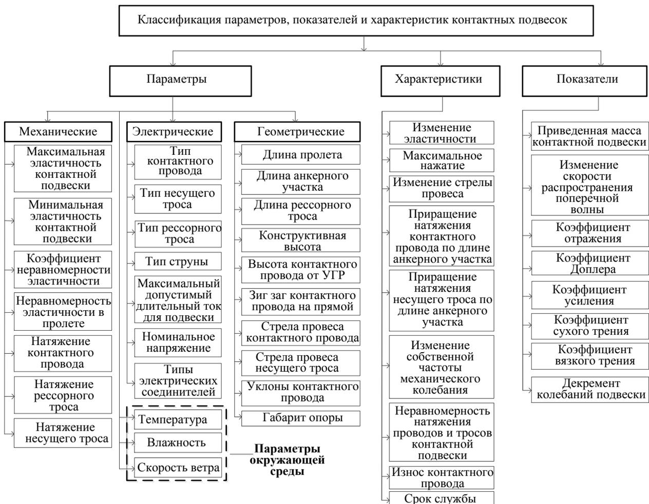
Рисунок 1 – Классификация параметров, показателей и характеристик контактных подвесок
