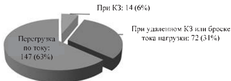
Рисунок 1 – Распределение числа отключений в зависимости от характера изменения тока в тяговой сети
