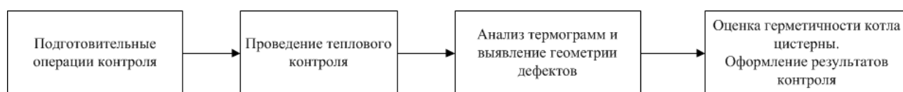
Рисунок 1 – Принципиальная схема теплового контроля
