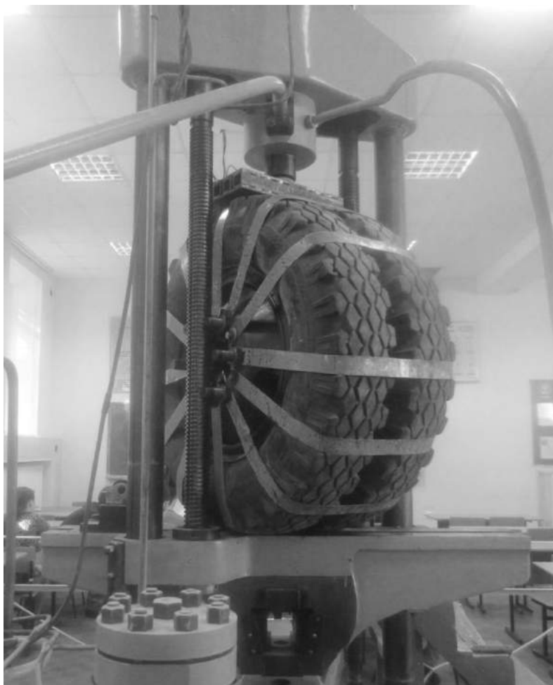
Рисунок 5 – Экспериментальные исследования нового рабочего органа катка с изменяющейся жесткостью
