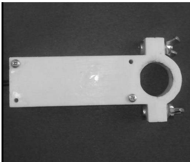
Рисунок 2 – Внешний вид конструкции крепления датчика к кабелю
