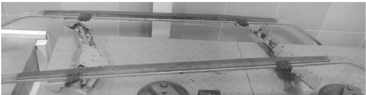
Рисунок 1 – Полоз токоприемника SSS87
