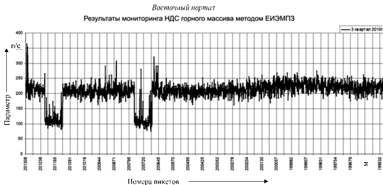
Рисунок 3 – Параметр активности электромагнитной эмиссии в строящемся Кузнецовском тоннеле ( n/c – количество импульсов в секунду)
