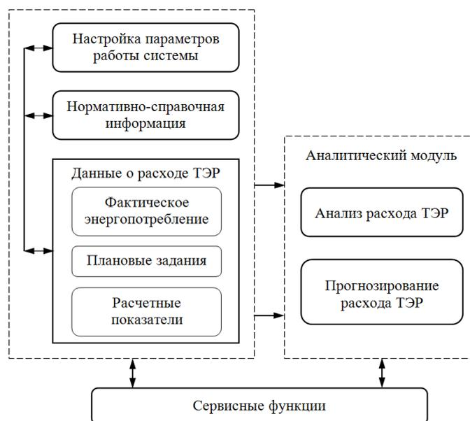
Рисунок 1 – Структурно-функциональная схема АИС МАПТЭР
