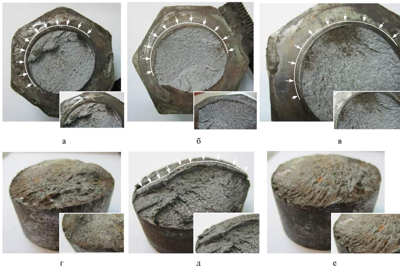
Рисунок 6 – Поверхности изломов болтов крепления ударной розетки автосцепного устройства к концевой балке: а – излом головки болта № 1; б – излом головки болта № 2; в – излом головки болта № 3; г – излом резьбовой части болта № 1; д – излом резьбовой части болта № 2; е – излом резьбовой части болта № 3
