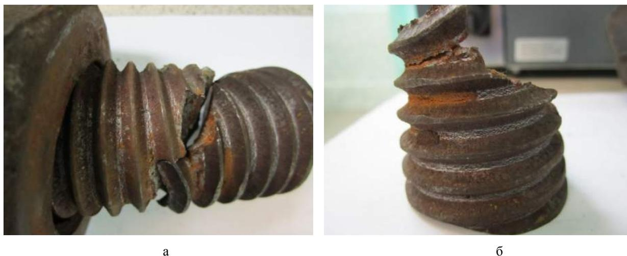
Рисунок 8 – Излом болта № 4 крепления ударной розетки автосцепного устройства:
