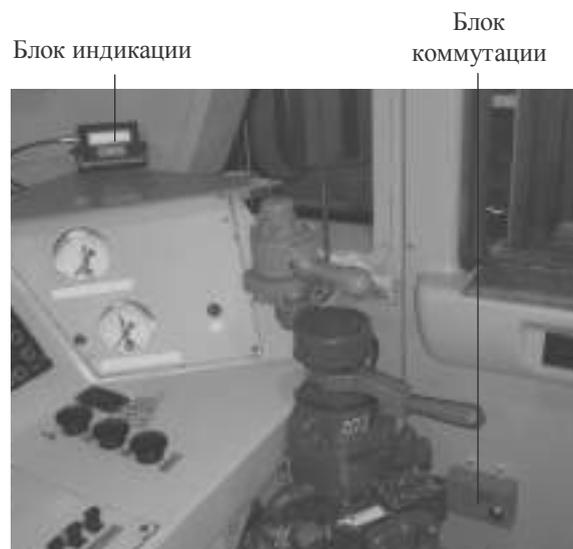
Рисунок 1 – Общий вид системы диагностики ТСП в кабине электровоза 2ЭС5К «Ермак»
