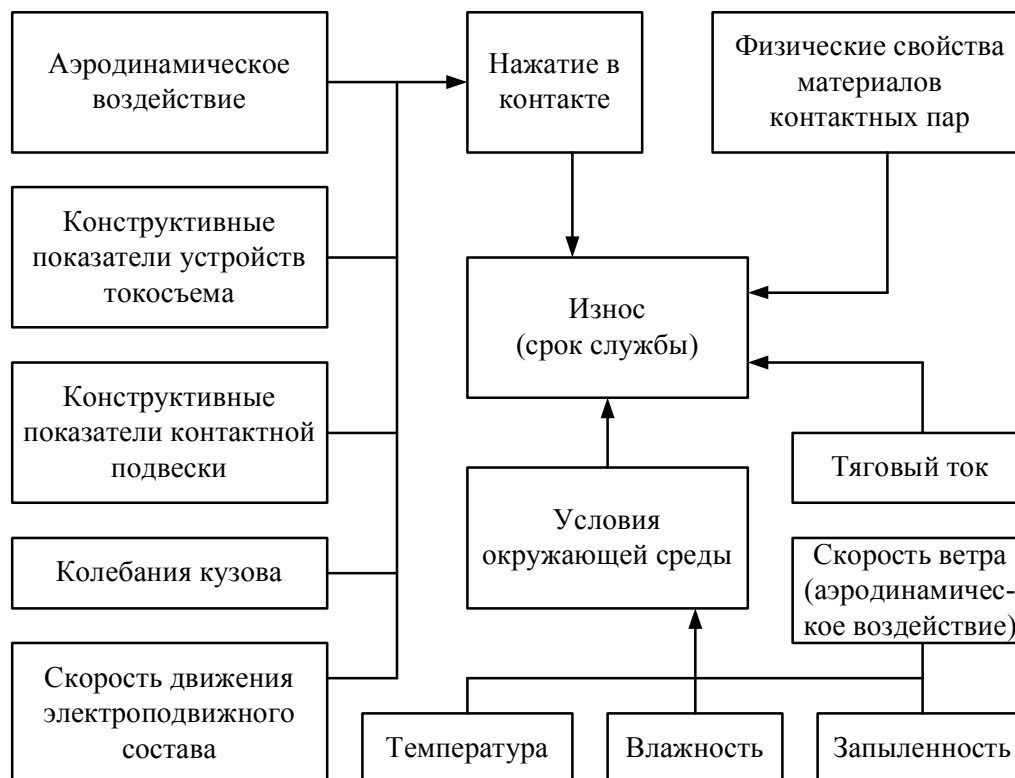
Рисунок 1 – Параметры, влияющие на износ элементов контактных пар
