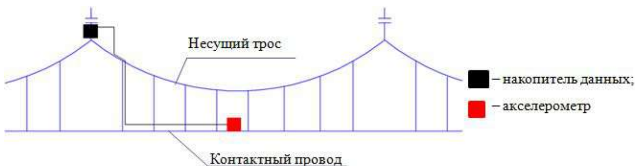
Рисунок 4 – Расположение элементов измерительной системы в пролете контактной сети
