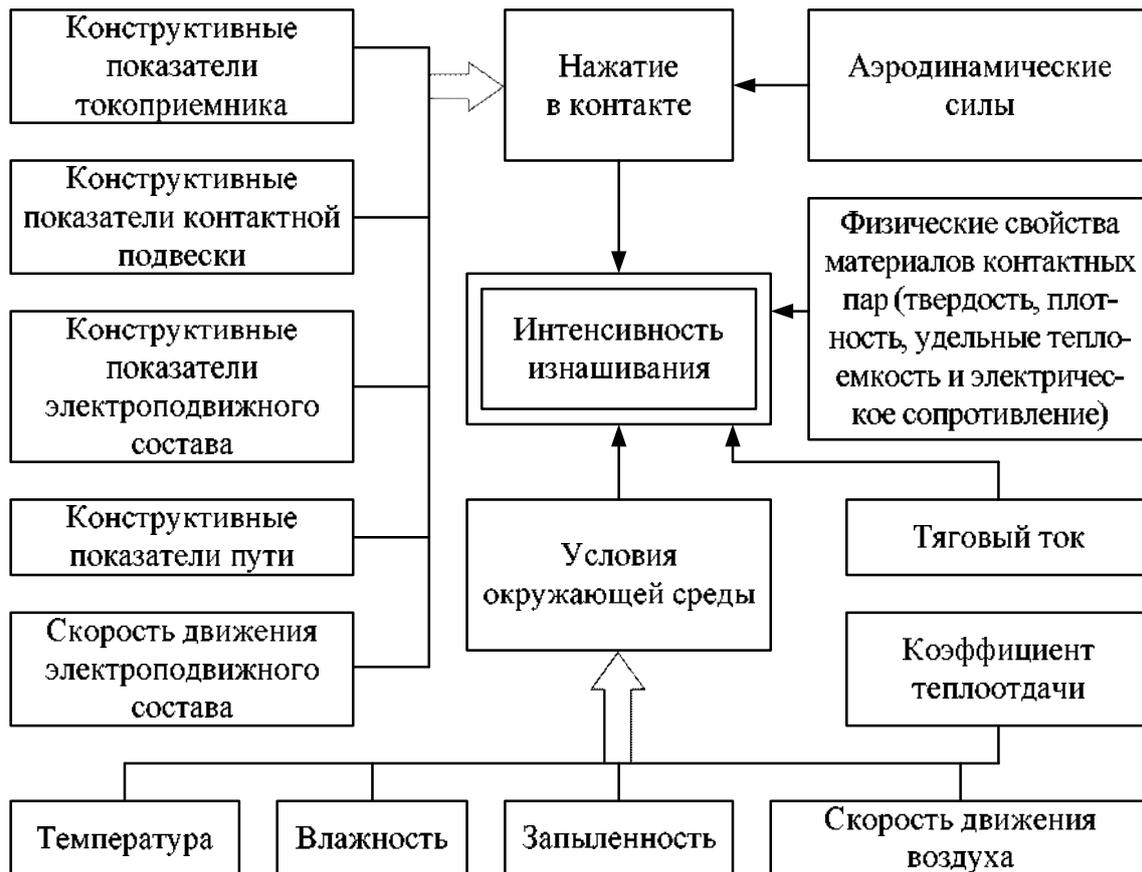
Рисунок 1 – Факторы, влияющие на интенсивность изнашивания элементов контактных пар
