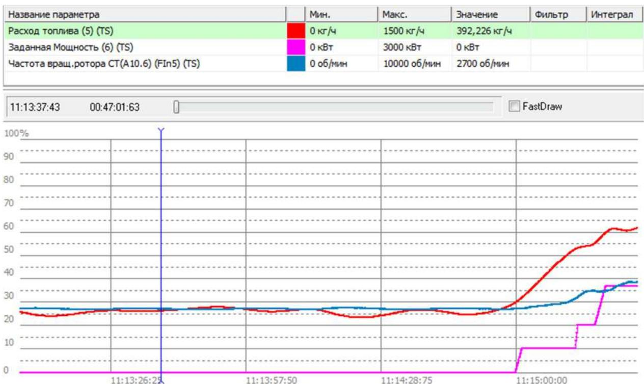
Рисунок 3 – Расход топлива при работе газотурбовоза на холостом ходу в улучшенном режиме
