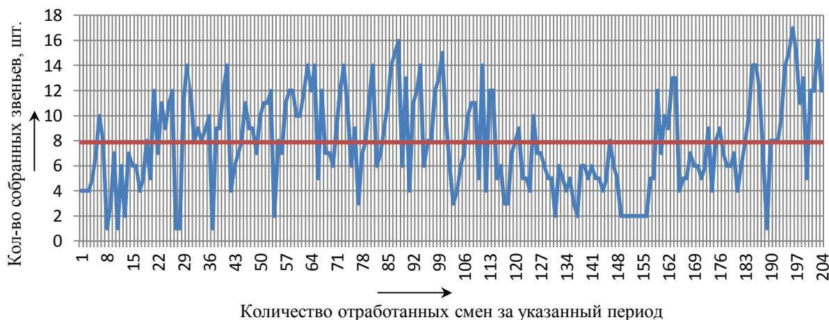
Рисунок 4 – График фактической производительности звеносборочной линии
