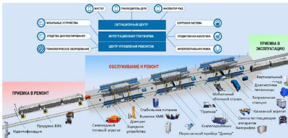
Рисунок 2 – Универсальная ремонтная канава в СЛД «Братск»
