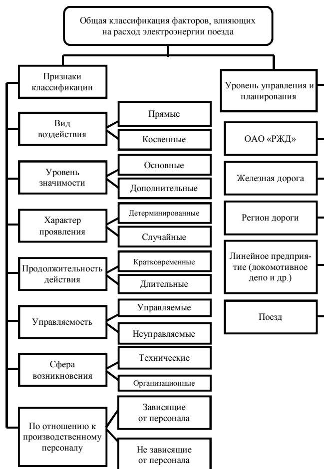
Рисунок 1 – Общая классификация факторов, влияющих на расход электроэнергии поезда
