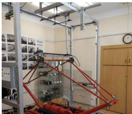
Рисунок 3 – Общий вид предлагаемой маятниковой ударной установки
