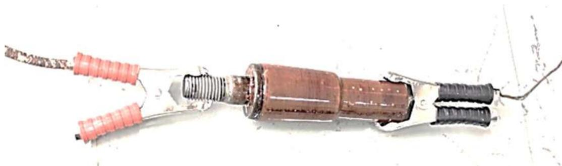
Рисунок 4 – Размещение зажимов подвода напряжения на изоляционном пальце тягового электродвигателя локомотива в процессе исследования электрической прочности изоляции
