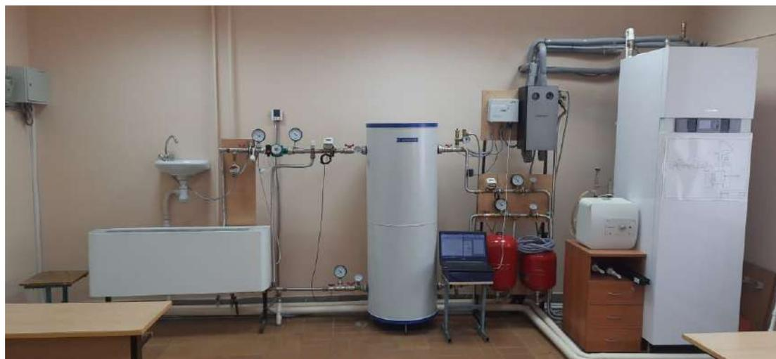
Рисунок 3 – Лабораторная теплонасосная установка с тепловым насосом Vitocal 242-S
