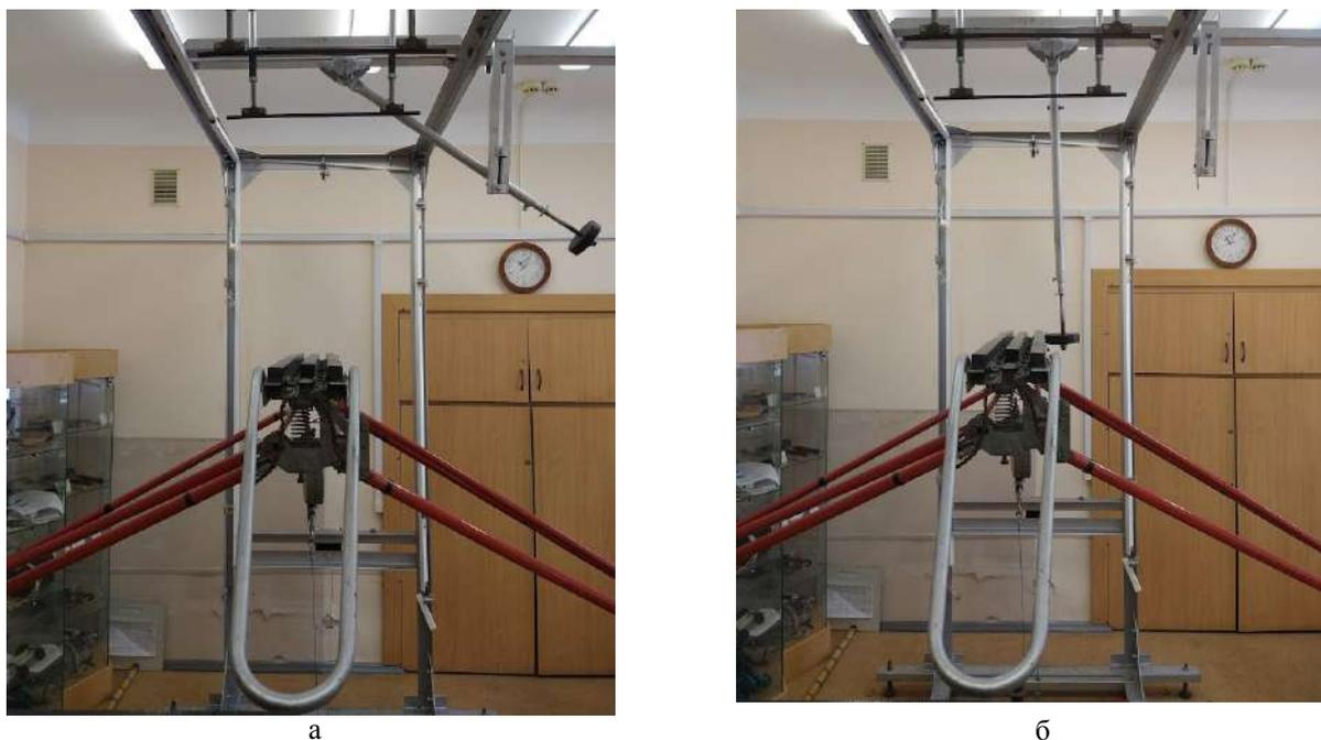
Рисунок 4 – Процесс испытания токоприемника на ударные воздействия:
