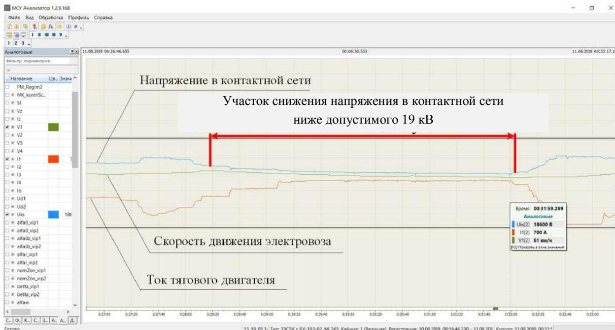
Рисунок 2 – Фрагмент расшифровки параметров движения электровоза ЗЭС5К №265 с поездом за период 10.08.2019 – 11.08.2019
