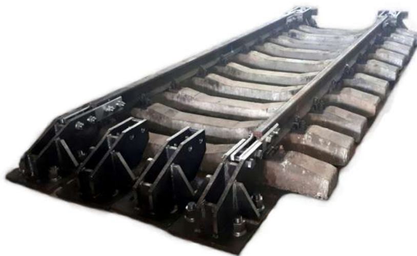
Рисунок 3 – Стенд для испытаний рельсошпальной решетки (вид сверху)
