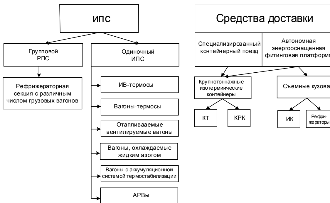
Рисунок 3 – Предлагаемая структура парка подвижного состава для транспортировки СПГ
