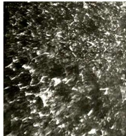
Рисунок 5 – Микроструктура на границе перехода ЗТВ (1) в основной металл (2),  $\times 100$
