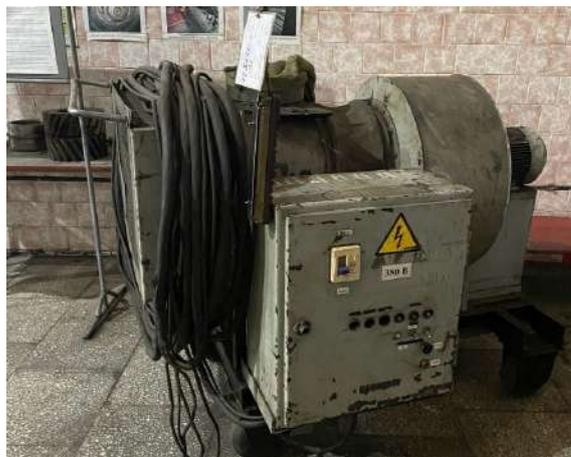
Рисунок 1 – Электрокалориферная установка для сушки изоляции ТЭД
