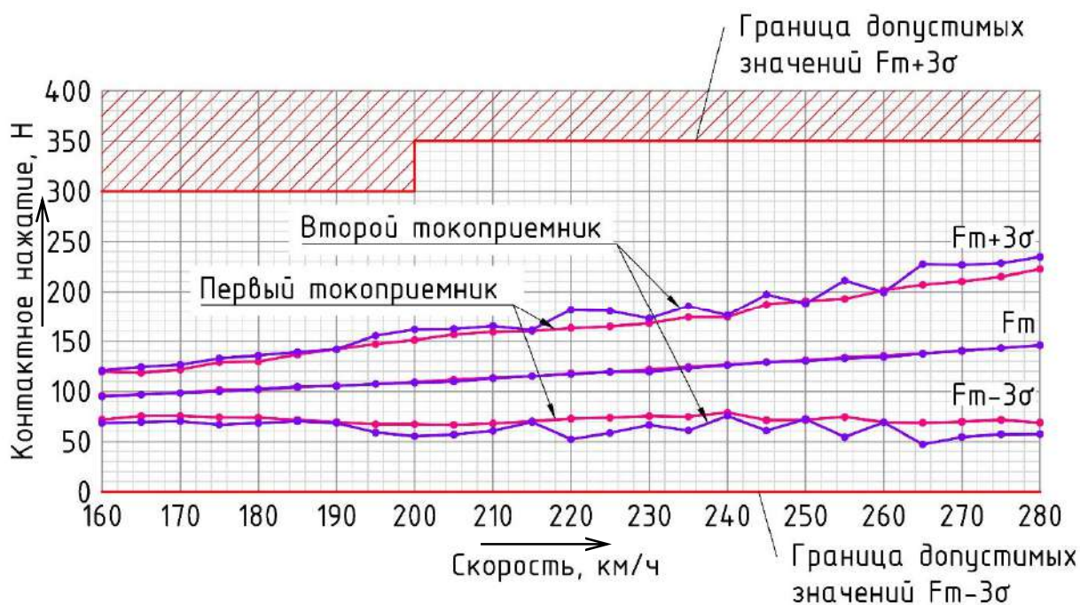
Рисунок 5 – Зависимость контактного нажатия от скорости при взаимодействии двух токоприемников ЭПС с рессорной контактной подвеской ПБСМ1-95 + Бр1Ф-120 (15 + 20 кН) при традиционном зигзаге КП1 (а) и предлагаемом зигзаге КП2 (б)
