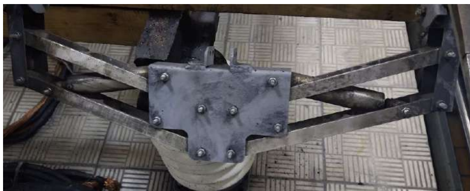
Рисунок 2 – Каретка рычажной конструкции токоприемника «Аист»
