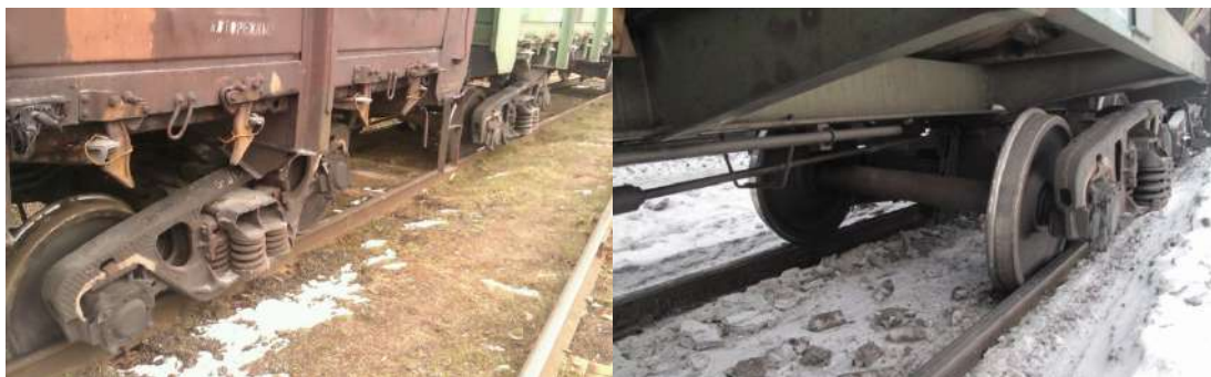
Рисунок 1 – Случаи проваливания колеса колесной пары внутрь колеи
