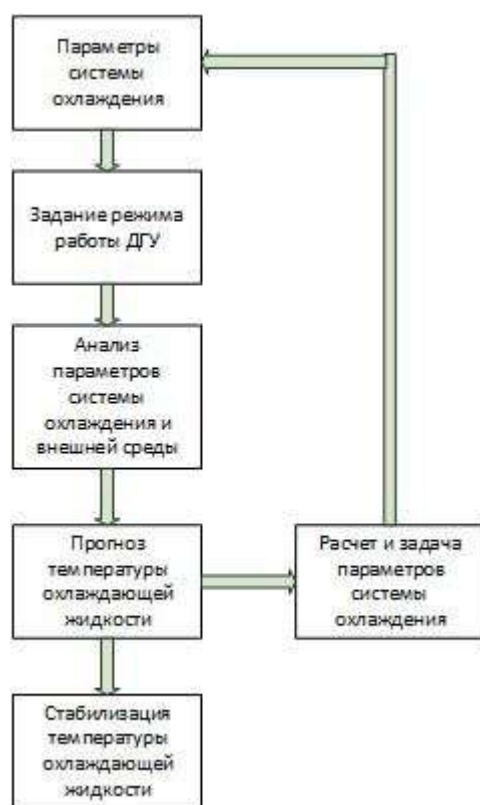
Рисунок 6 – Пример схемы формирования алгоритма управления стабилизацией температурного режима
