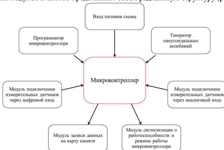
Рисунок 2 – Взаимодействие функциональных модулей электрической схемы измерительного блока
