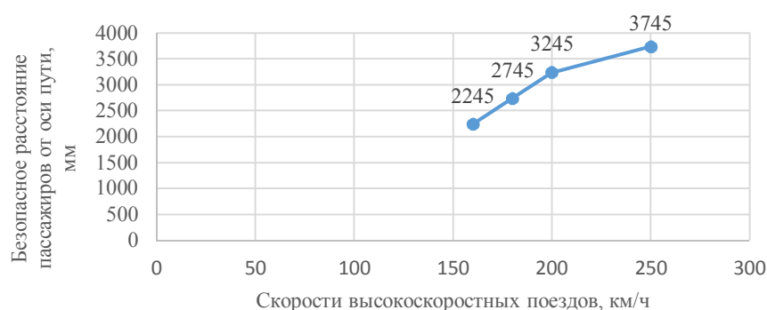
Рисунок 1– Безопасное расстояние пассажиров от оси пути
