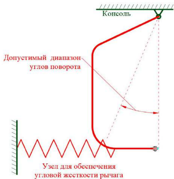
Рисунок 3 – Схема крепления рычагов к консоли для ограничения подвижности КП поперек оси пути
