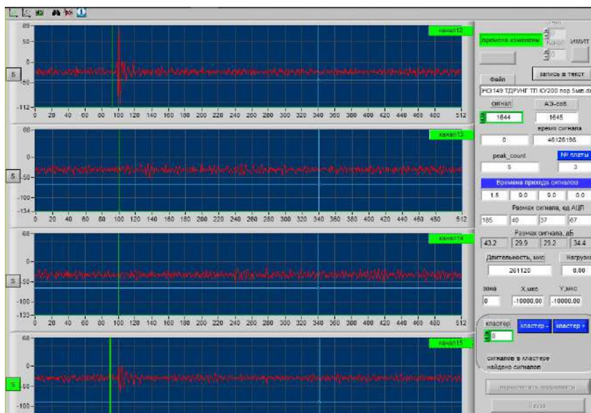
Рисунок 7 – Форма сигнала «Измерение 1» при наличии ЧР
