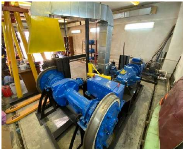
Рисунок 10 – Внешний вид стенда для исследования параметров тормозного нажатия колодки на колесо
