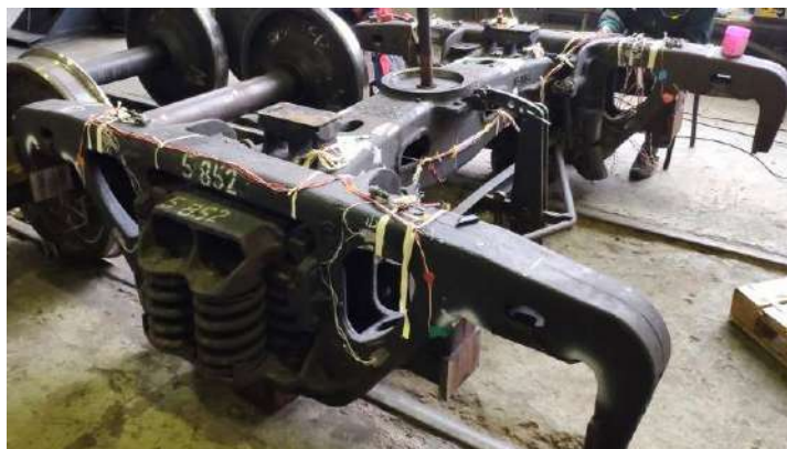
Рисунок 4 – Подготовка тележки вагона к испытаниям и наклейка на нее тензорезисторов
