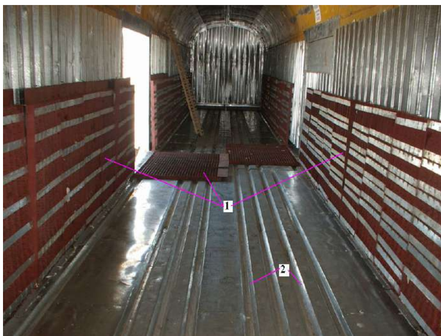
Рисунок 1 – Транспортное средство, оборудованное ограждающими конструкциями из рекомендуемых теплоизолирующих материалов [7]: 1 – расположение напольных решеток; 2 – пол грузового помещения ТС
