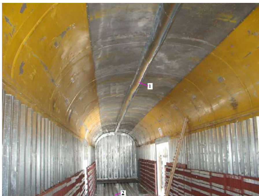
Рисунок 2 – Грузовое помещение с новой системой охлаждения (например, посредством жидкого азота):
