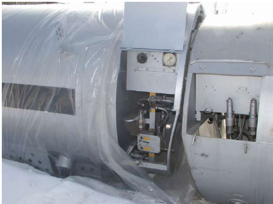
Рисунок 3 – Установка УПА1-0,05 для подачи жидкого азота в грузовое помещение ТС
