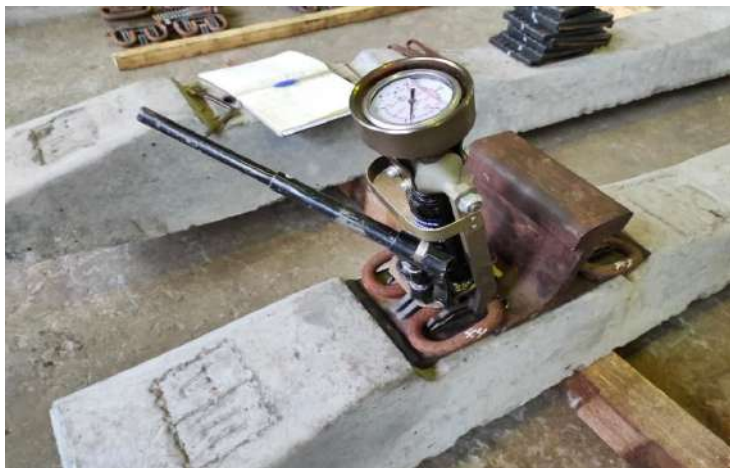
Рисунок 2 – Приспособление для измерения усилия прижатия подошвы рельса к шпале с использованием измерительного ключа АпАТЭК
