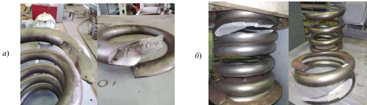
Рисунок 6 – Виды изломов пружин: а – разрушение первого витка от контакта с опорным; б – разрушение от дефектов материала прутка
