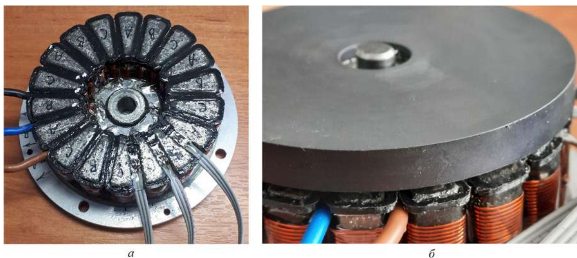
Рисунок 7 – Экспериментальный образец электродвигателя с АМП: статор (а); статор и установленный на него сверху ротор (б)
