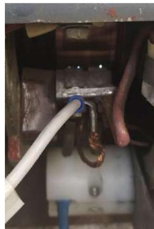
Рисунок 3 – Внешний вид пьезоэлектрического датчика (белый цилиндр в нижней части рисунка), установленного на траверсу
