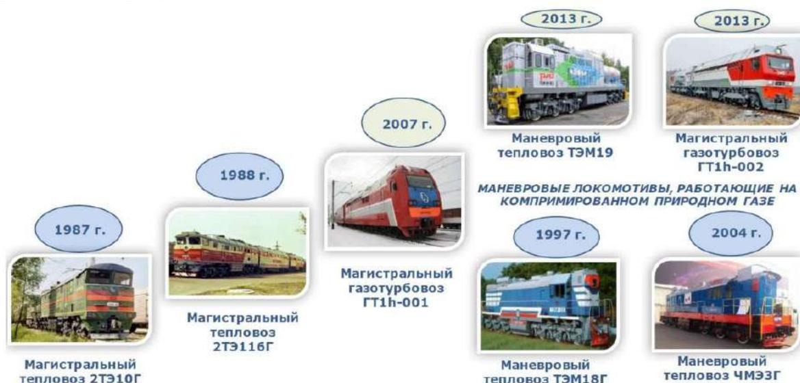
Рисунок 1 – Проекты конвертирования автономных локомотивов на сжиженный природный газ [2]
