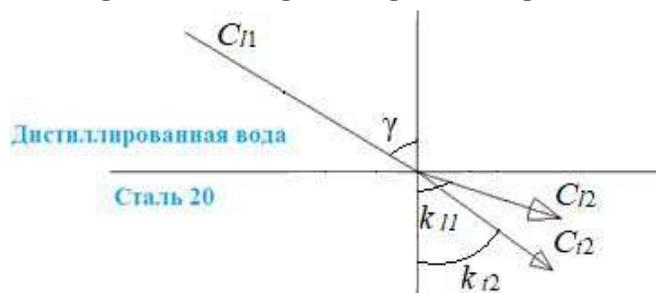
Рисунок 6 – Схема образования преломленных волн в стали при падении УЗ-колебаний под углом  $\gamma$
