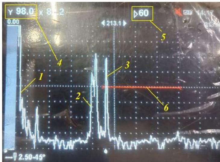
Рисунок 7 – Вид экрана дефектоскопа УД2-102ВД: 1 – зондирующий импульс; 2 – сигнал, отраженный от поверхности образца; 3 – сигнал от отверстия диаметром 3 мм; 4 – расстояние до отверстия диаметром 3 мм; 5 – усиление дефектоскопа; 6 – браковочный уровень
