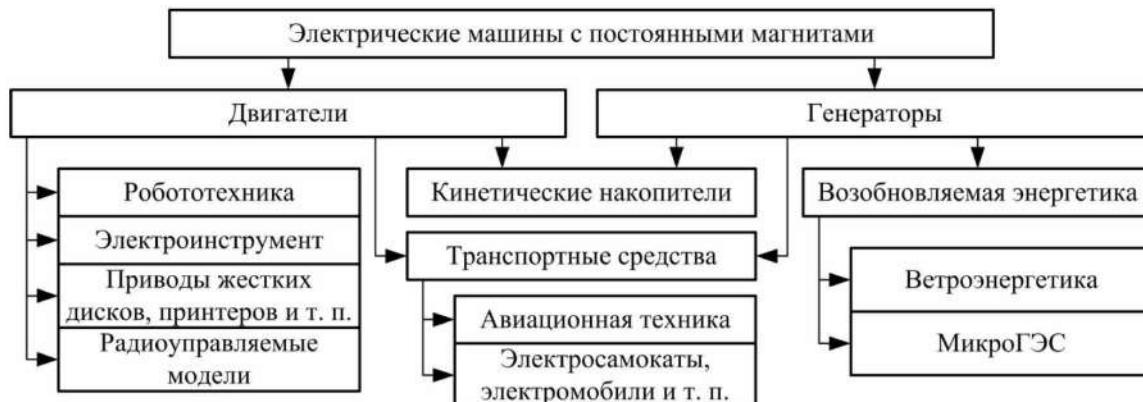
Рисунок 1 – Области применения электрических машин с постоянными магнитами
