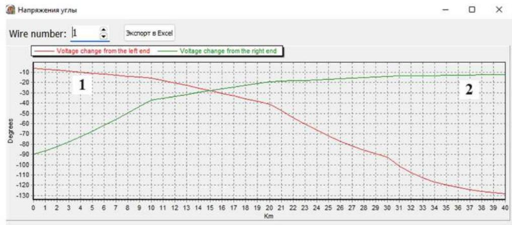
Рисунок 10 – Графики углов напряжений в контактном проводе первого пути, полученные в ПВК «ОМПКЗ» для т. 1 (1215)
