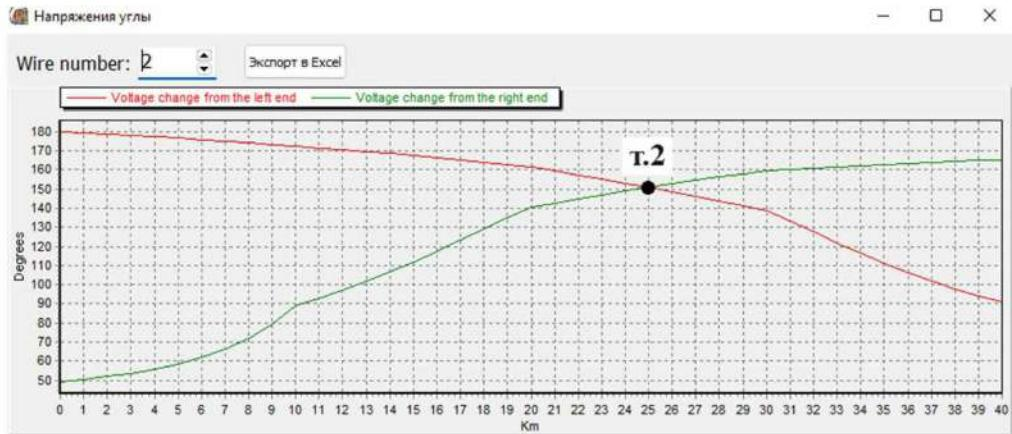
Рисунок 14 – Графики углов напряжений в питающем проводе первого пути, полученные в ПВК «ОМПКЗ» для т. 2 (1025)
