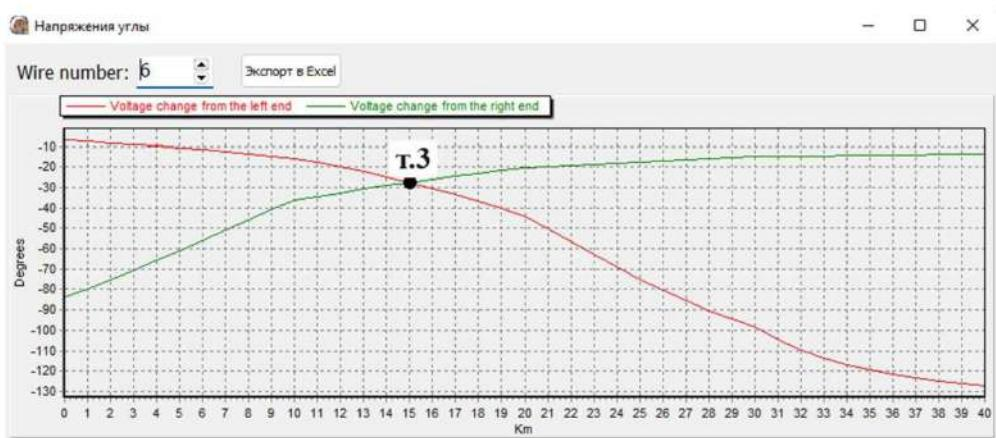
Рисунок 16 – Графики углов напряжений в проводе ДПР второго пути, полученные в ПВК «ОМПКЗ» для т. 3 (1915)
