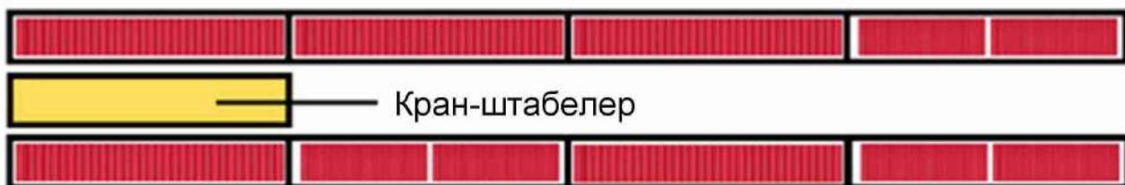
Рисунок 5 – Стеллажная система хранения при применении транспортно-перегрузочного крана-штабелера – боковое расположение контейнеров (вид сверху)
