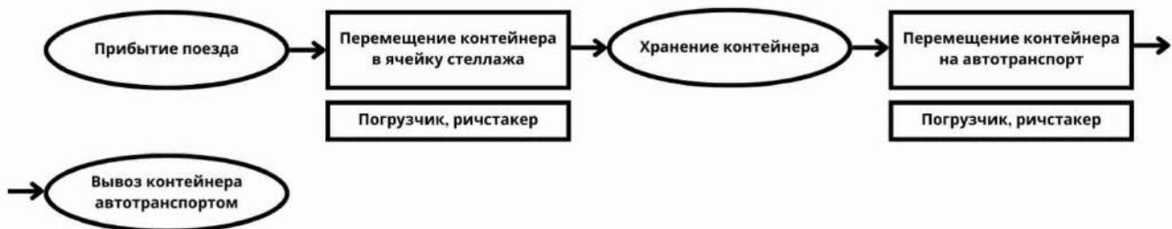
Рисунок 4 – Технология обработки контейнера при стеллажной системе хранения по первому варианту
