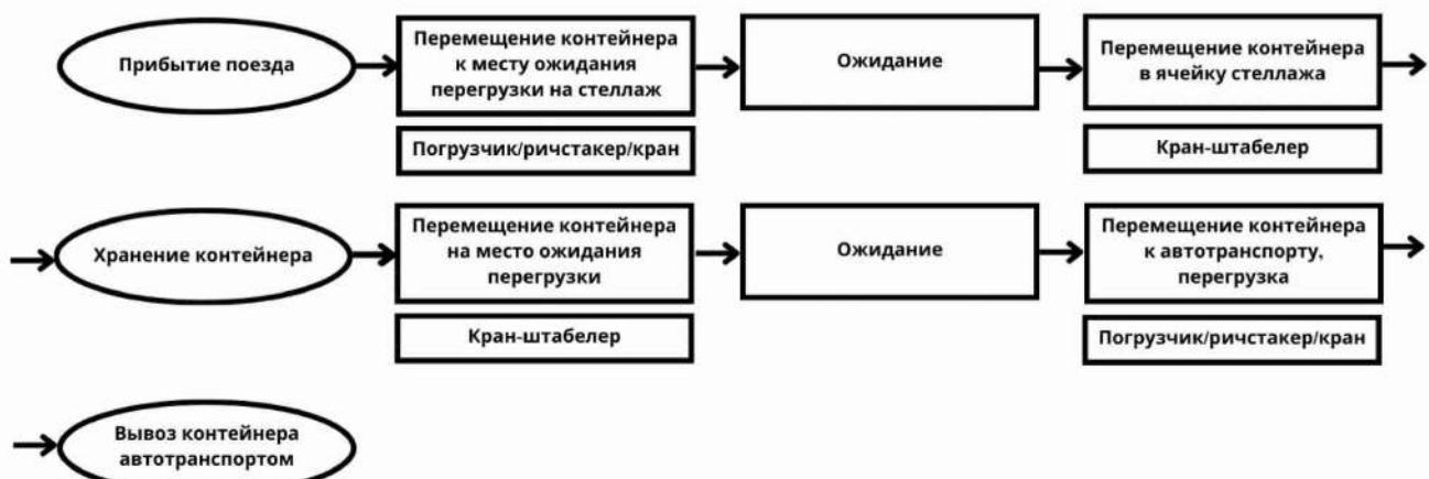
Рисунок 7 – Технология обработки контейнера при стеллажной системе хранения по второму и третьему вариантам
