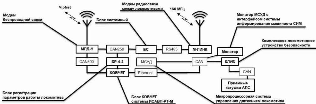
Рисунок 1 – Взаимодействие локомотивных устройств при реализации «Виртуальной сцепки»
