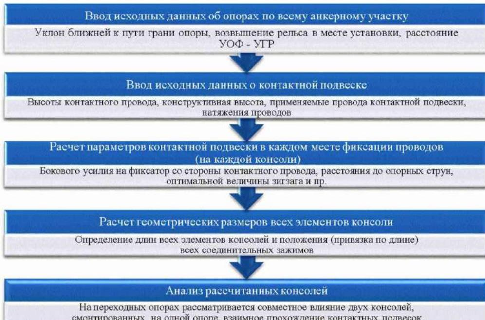
Рисунок 4 – Порядок расчета геометрии консоли
