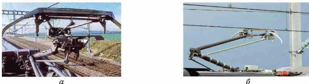
Рисунок 2 – Французские высокоскоростные токоприемники: *а* – серии *AMDE*; *б* – серии *CX*
