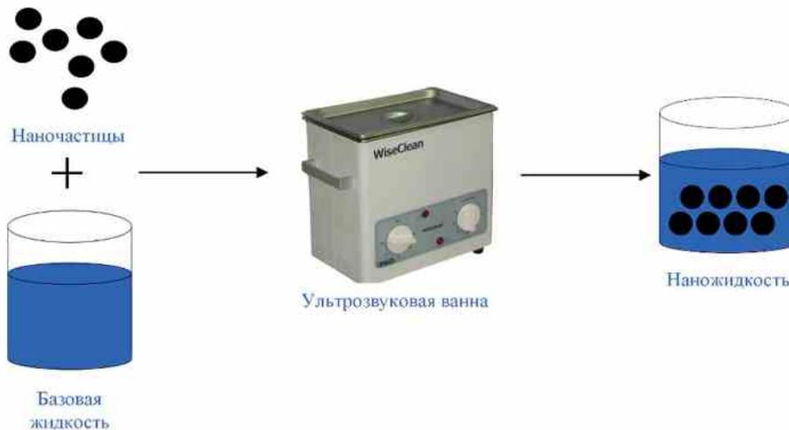
Рисунок 5 – Двухстадийный метод подготовки наножидкости
