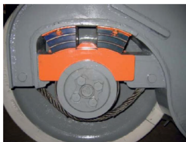
Рисунок 7 – Первая ступень подвешивания тележки модели 18-9750 в виде полиуретано-металлических амортизаторов
