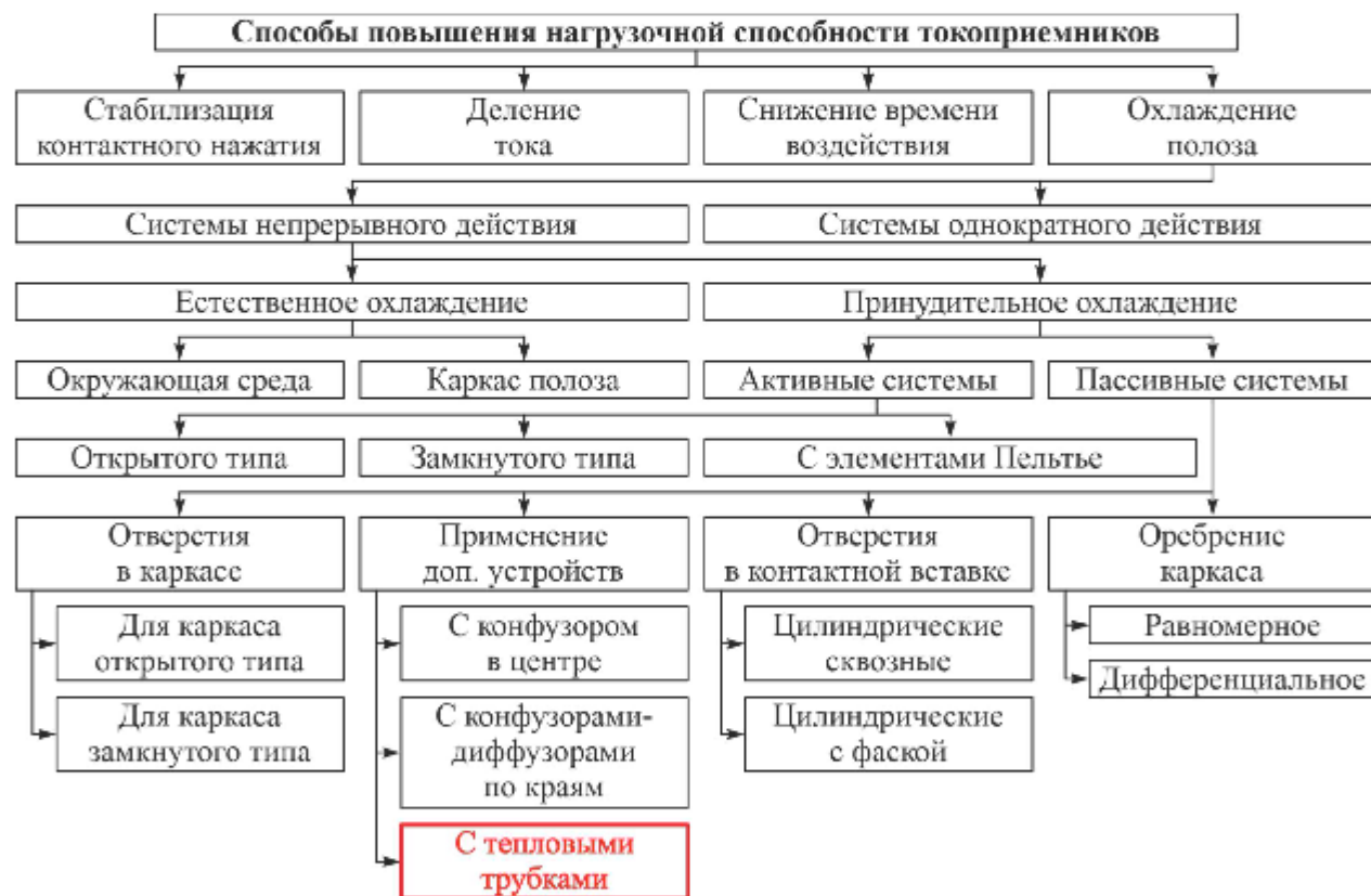
Рисунок 2 – Способы повышения нагрузочной способности токоприемников
