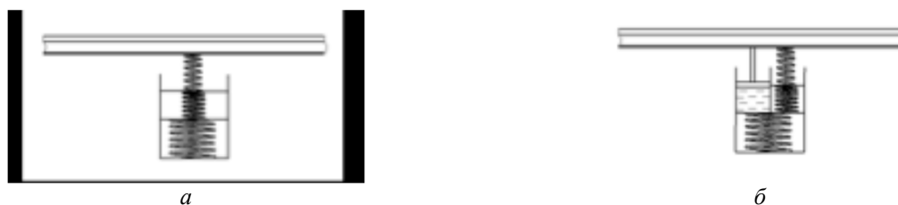
Рисунок 6 – Схемы упругого и упруговязкого «скелетов» пути из упругих элементов (а) и по модели Максвелла (б)
