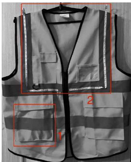
Рисунок 3 – Модернизированный сигнальный жилет со встроенной системой оповещения: 1 – приемный модуль (контроллер), обеспечивающий прием сигнала от передатчика и управление звуковой и световой индикацией; 2 – светодиодная лента, обеспечивающая визуальное оповещение работников в случае приближения подвижного состава
